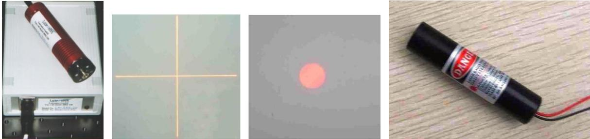
Die Abmessungen dieser ‚kleinen Laserdiodenmodule und YAG-Laser‘ sind typischerweise 12 mm Durchmesser bei ca. 40 mm Länge. Durch spezielle Optiken können Kontouren wie Strich, Kreuz, Gittermuster etc. erzeugt werden. Mit Hilfe eines Galvoscanners können auch softwaregesteuert beliebige Kontouren erzeugt werden.
