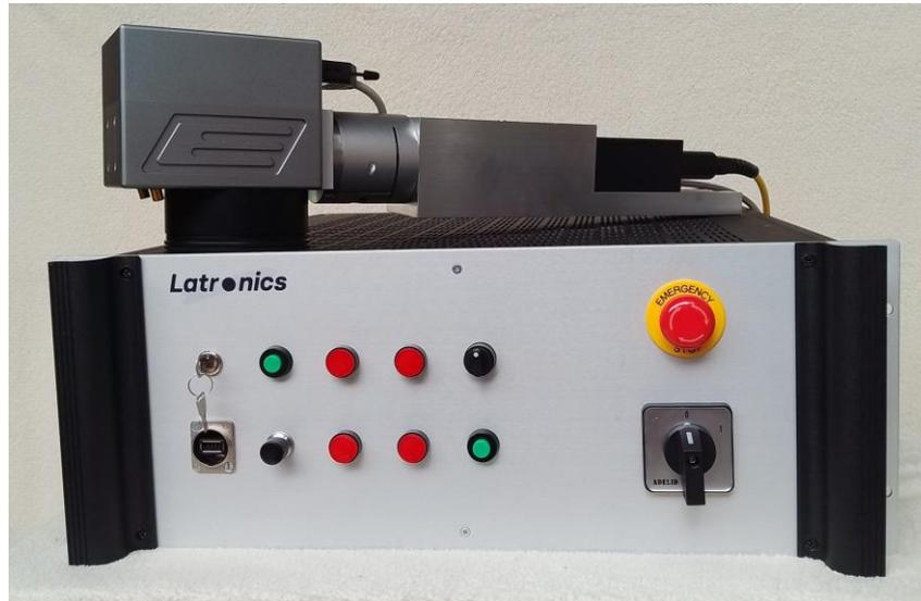
OEM-System mit softwaregesteuertem Galvoscanter. Die Bedienelemente befinden sich an der Frontplatte des 19" Steuerungsgehäuses. Sie können bei einer Systemintegration aber auch durch die entsprechenden Bedienelemente einer übergeordneten Steuerung ersetzt werden.
